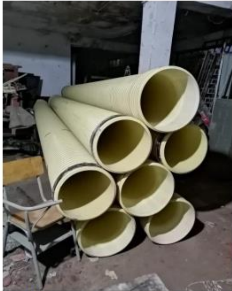
Foto 11. Tubo de 18 pulgadas para alcantarillado
